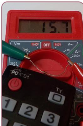
▼ Fig. 3. Diferencia de potencial en el diodo con una fuente infrarroja.
