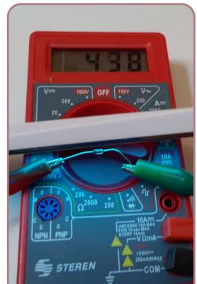
▼ Fig. 6. Diferencia de potencial en el diodo con una fuente UVC.
