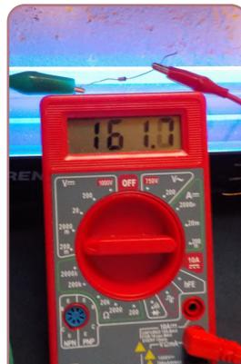
▼ Fig. 5. Diferencia de potencial en el diodo con una fuente UVA.
