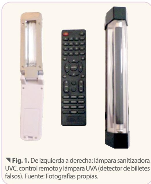
▼ Fig. 1. De izquierda a derecha: lámpara sanitizadora UVC, control remoto y lámpara UVA (detector de billetes falsos). Fuente: Fotografías propias.
